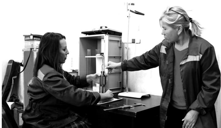
«Одним из основных испытаний является определение эквивалента дробленого песка, или, как часто мы его называем, отсева», – рассказала заместитель начальника ЦИЛ ПАО «Дорисс» Вера Апполонова. – Суть метода заключается в определении соотноше-
